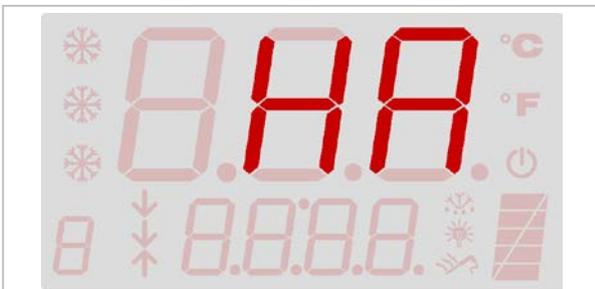
Si, à cause d'anomalies de fonctionnement, l'installation électrique a une consommation de courant supérieure aux valeurs admises, un relais thermique interviendra pour arrêter l'appareil. Telle intervention est signalée par l'affichage sur l'écran du message "**HA**". Dans le cas où le relais thermique soit intervenu on doit le réarmer manuellement.
