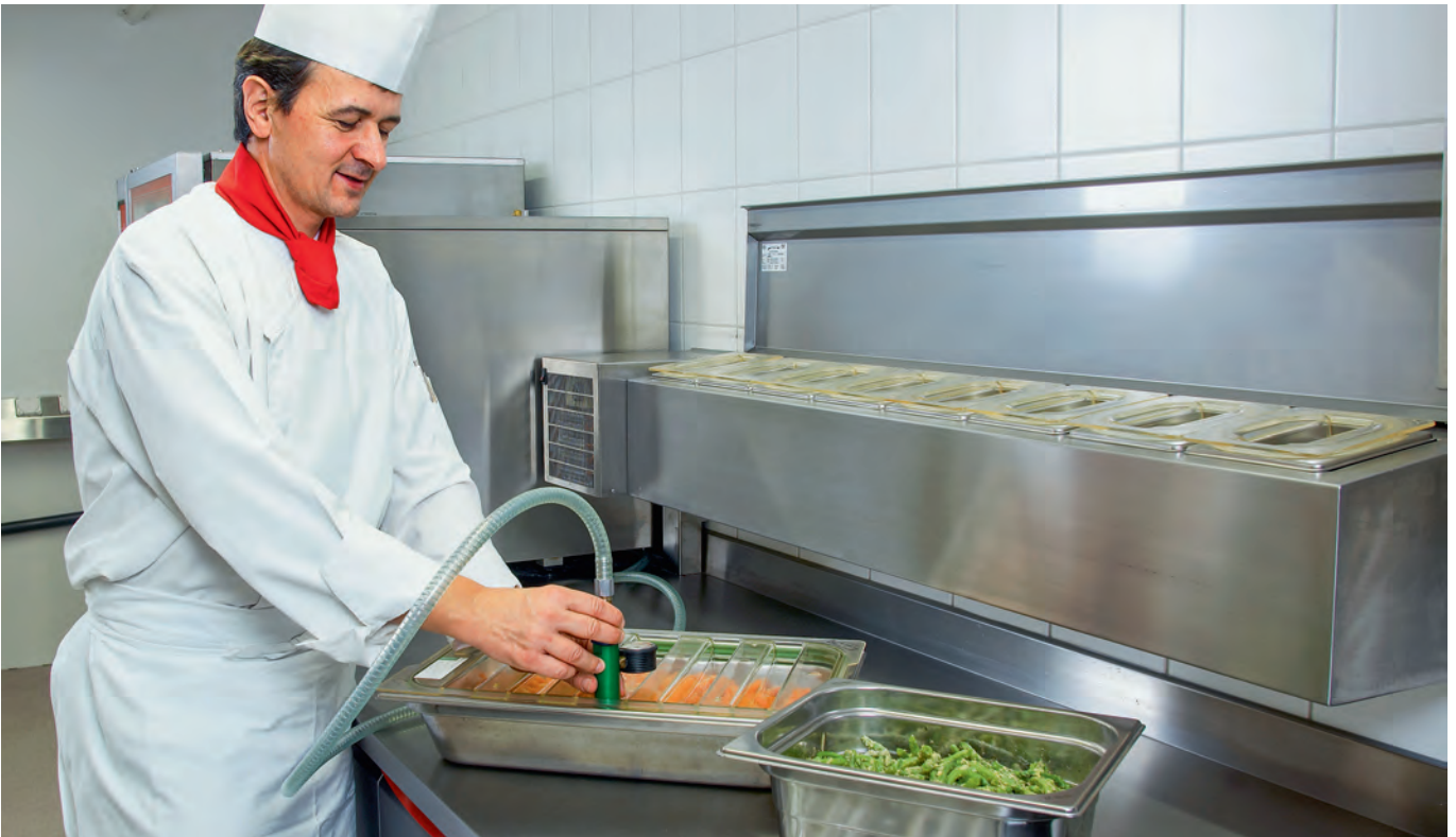
Garheiss kommt das Gemüse in die GreenVac-Schalen (oben). Der Schockfroster kühlt das Gargut innert 30 Minuten auf 3 Grad hinunter (Mitte); danach wird ihm Luft entzogen (unten). So bleibt es sieben Tage haltbar.
