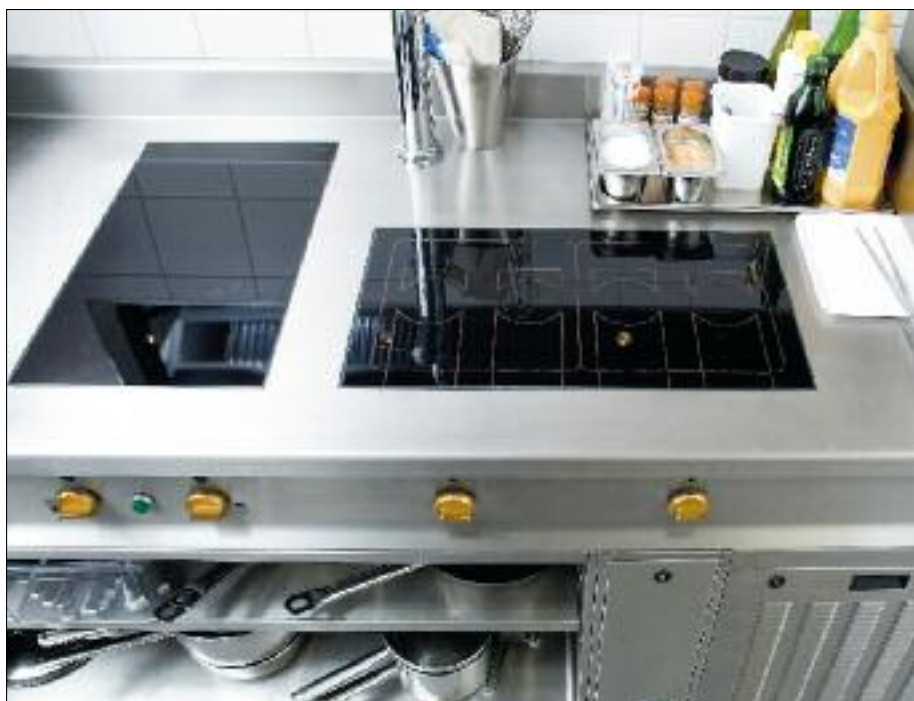
Blick auf die Herdoberfläche: Flächenbündig quer eingebaute Induktionskochfelder, daneben die hintereinander liegenden Ceran-Grosskochfelder.
