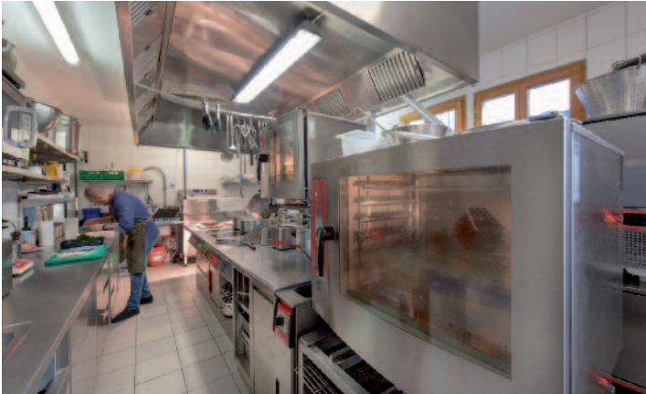
Der Frigojet 5 x 1/1 GN Cubo in platzsparender Doppelstockanordnung und die beiden Practico Vision Plus Kombisteamer mit 6 x 2/3 GN und 6 x 1/1 GN ermöglichen maximale Flexibilität bei gleichzeitiger Vorproduktion, A la Carte- und Bankettzubereitung zu.
